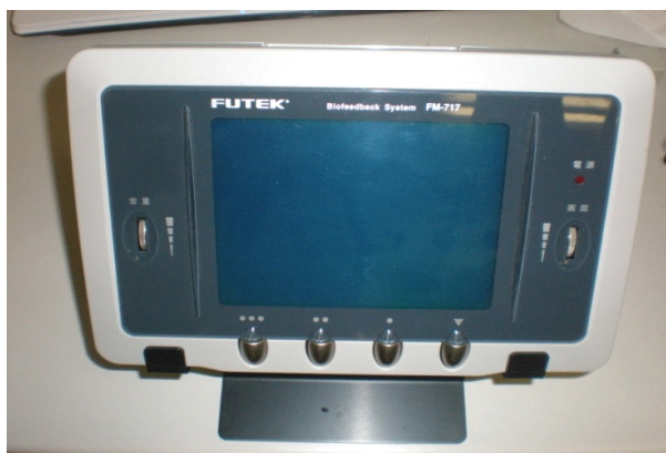
図-2 簡易脳波測定器
